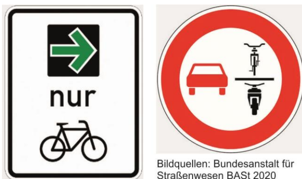
Bild 12: Neue Beschilderung Grünpfeil für den Radverkehr und Überholverbot von Zweirädern
